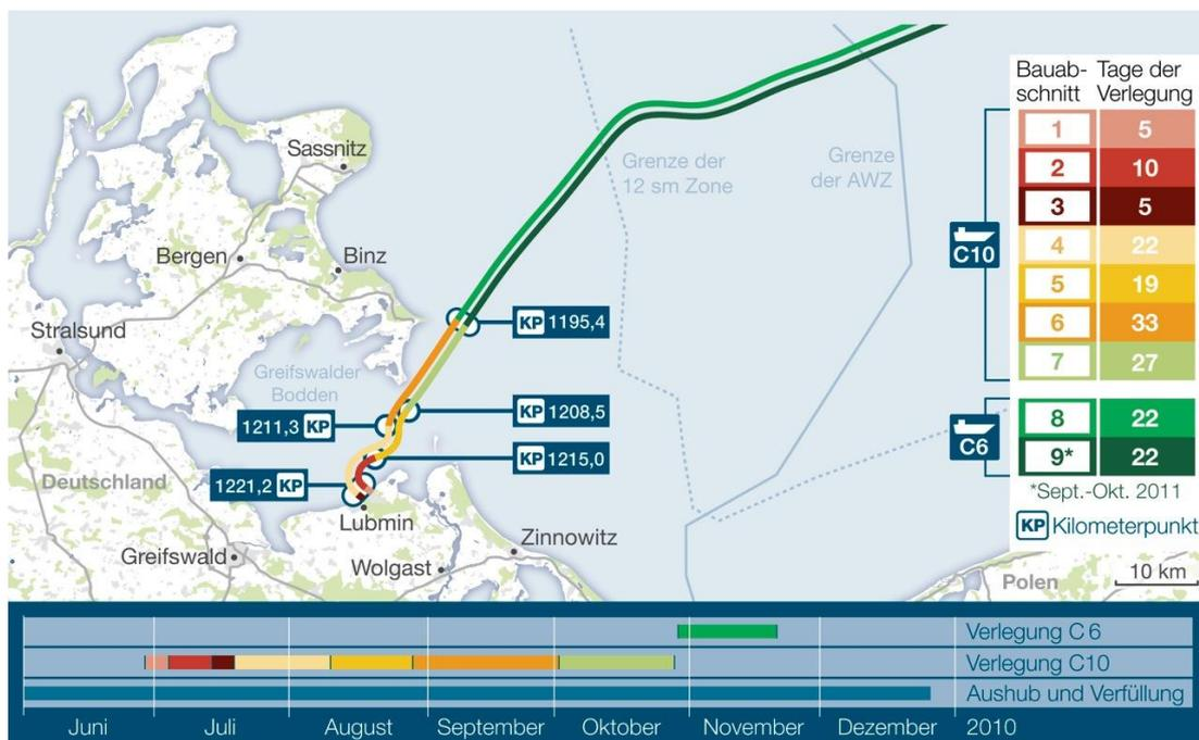
Abb. 1: Verlegung der Nord Stream-Pipeline: Um die Orientierung und Positionierung entlang der Pipelinerroute zu vereinfachen, wurden so genannte Kilometerpunkte (KP) eingeführt.
