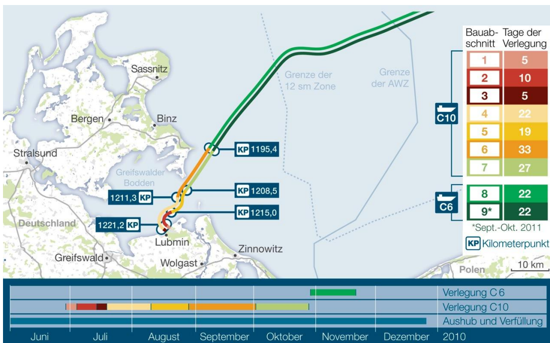
Abb. 1: Verlegung der Nord Stream-Pipeline: Um die Orientierung und Positionierung entlang der Pipelinerroute zu vereinfachen, wurden so genannte Kilometerpunkte (KP) eingeführt.
