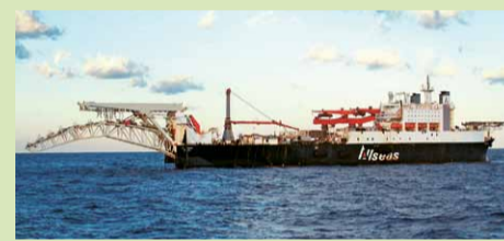
Mit 300 Metern Länge ist die Solitaire das grösste Verlegeschiff der Welt.
