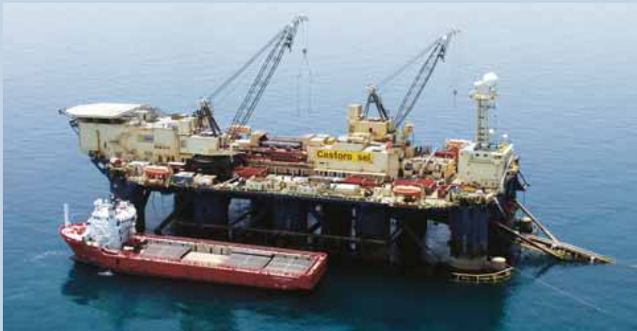
Позиционирование судна Castoro Sei осуществляется с помощью системы якорей и движителей
