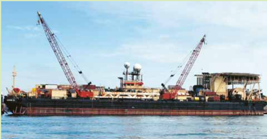
Судно Castoro Dieci является идеальным судном для трубоукладки на мелководье
