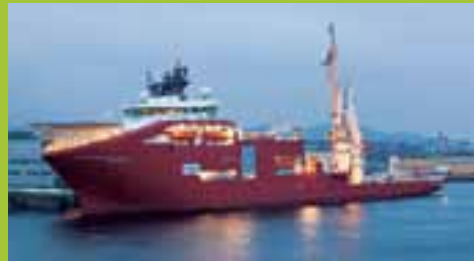
Der Kran am Heck der Skandi Arctic kann Lasten von bis zu 400 Tonnen heben.
