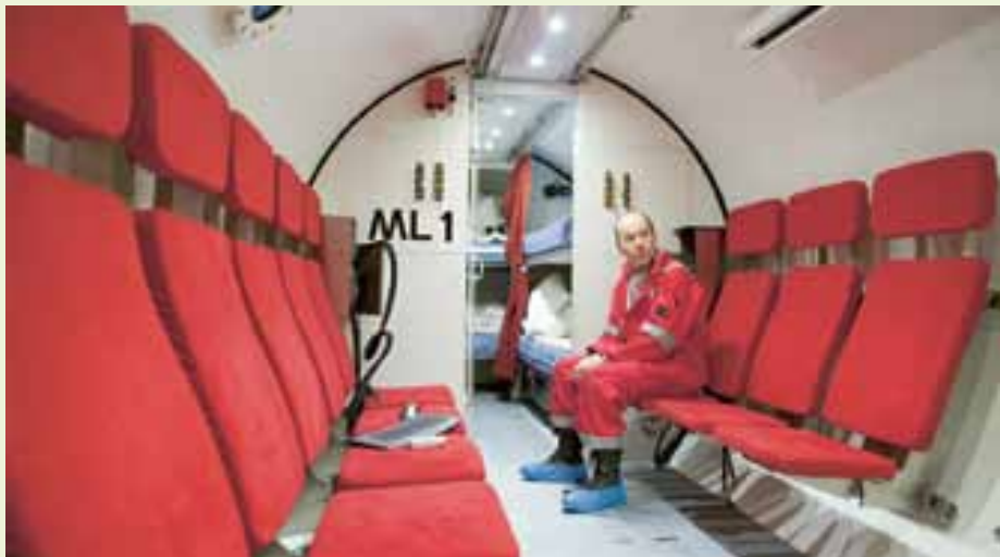
In der Tauchkammer, die Raum für 24 Taucher bietet, herrscht ein konstanter Überdruck.
