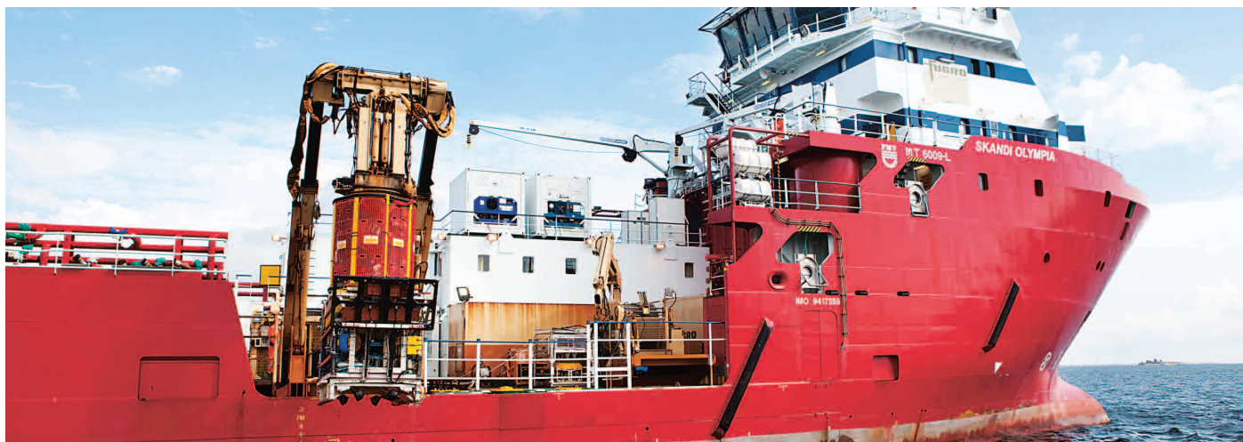
Die Besatzung des Forschungsschiffs Skandi Arctic hebt den Tauchroboter, der die Pipeline unter Wasser inspiziert, aus der Ostsee.
