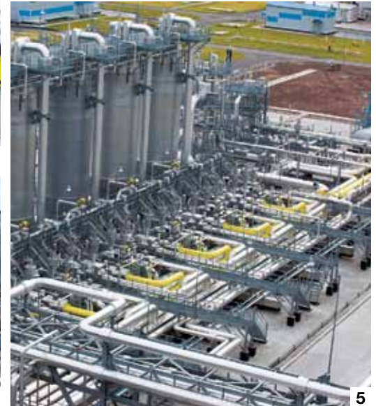
1) und 2) Eine Gaspumpeinheit resp. ein Kompressor, angetrieben durch einen Rolls Royce-Motor. 3) Im Vordergrund die Gasaufbereitungsanlage, dahinter die acht Kompressorereinheiten. 4) und 5) Die Aufbereitungsanlage entfernt Kondensate aus dem Gas, das durch die Gryazovets-Wyborg-Pipeline angeliefert wird.
