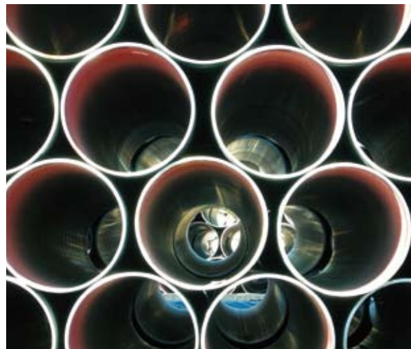
Ein Rohrstück ist zwölf Meter lang, der Durchmesser beträgt 48 Zoll.
