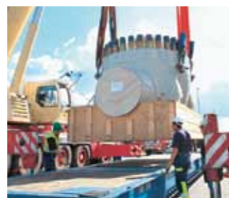
Das 102-t-Ventil wird auf einen 26 m langen LKW mit 16 Achsen verladen.
