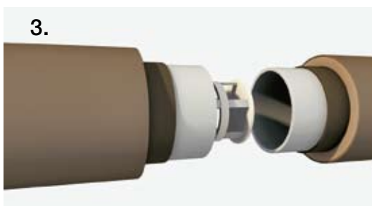
3. Innen und außen Schweißen Jedes Rohr wird durch komplexe Schweißvorgänge mit der Pipeline verbunden. Jede einzelne Schweißnaht wird mit Ultraschall geprüft und versiegelt.
