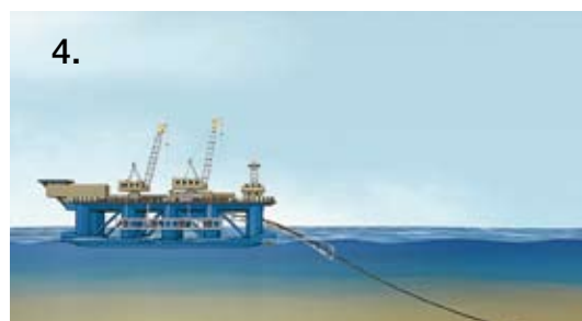
4. Ablassen auf den Meeresboden Während die Pipeline länger wird, bewegt sich das Verlegeschiff, das sie auf den Meeresboden absenkt, vorwärts. Auf diese Weise werden bis zu 3 km Pipeline am Tag verlegt.
