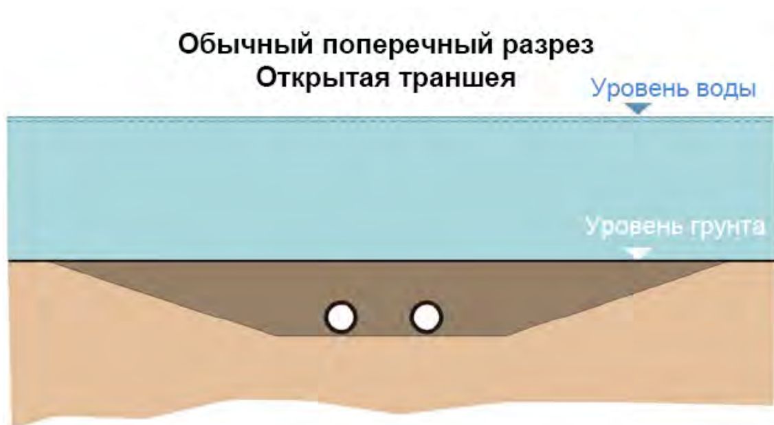
Рис. 3.10 Обычный поперечный разрез – открытая траншея в районе выхода на берег Германии
