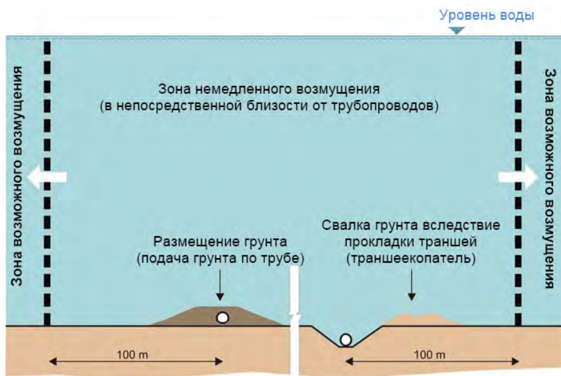
Рис. 4.2 Нарушение среды в непосредственной близости от трубопровода
