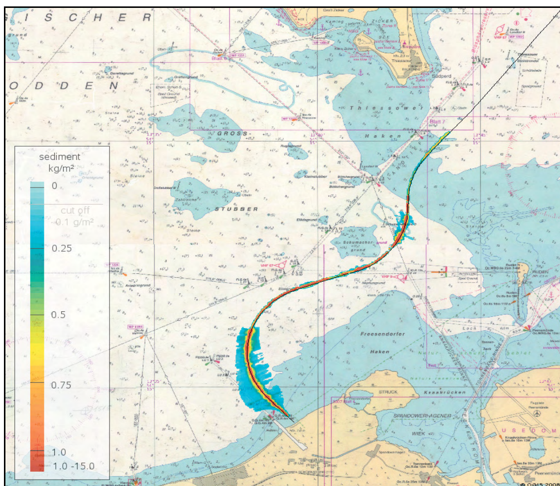
Рис. 4.8 Обзор показателей седиментации (в \text{kg/m}^2 ) для всех направлений ветра при скорости ветра 5 м/с и интервале вмешательства 5 дней
