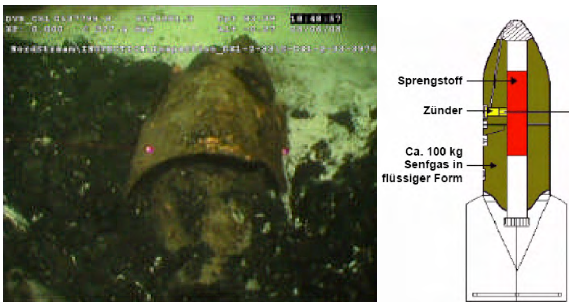
Abbildung 2.23 DK1-2-33-3976, eine deutsche chemische Senfgasbombe (250) aus dem Zweiten Weltkrieg. Die Hülse ist stark korrodiert und es ist noch Gas in der Bombe vorhanden, bis zu ca. 30 kg
