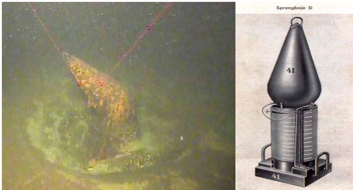
Abbildung 2.22 Target R-09-04, Minenlinien-Reiß-Sprengvorrichtung aus dem Weltkrieg, konische Hülse mit abgerundetem Sockel, ruht auf den möglichen Überresten seines Verlegsystems in einem ausgespülten Hohlraum auf einem Boden aus sandigem Ton. Identifikation: SPB D deutsche Sperrmine, Ladung 0,8 kg, äußere Kennzeichen Stoß/Ziehensor
