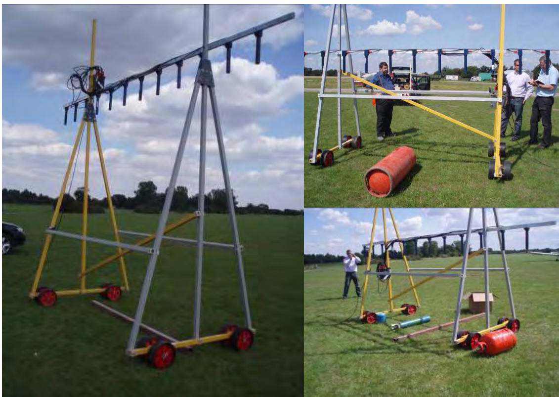
Рис. 2.12 Береговые приемочные испытания массива градиометров
