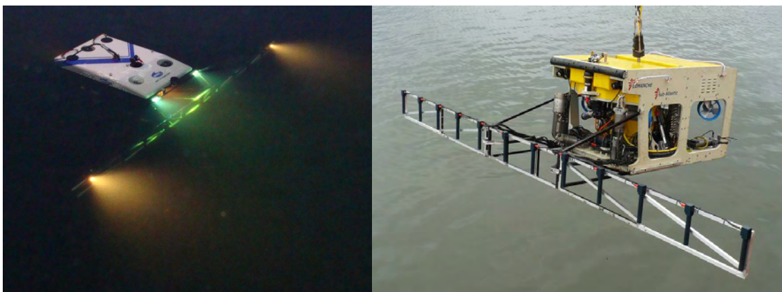
Рис. 2.11 Стрела градиометра, установленная на АДУ: российский сектор (слева), финский, шведский, датский, германский секторы (справа)
