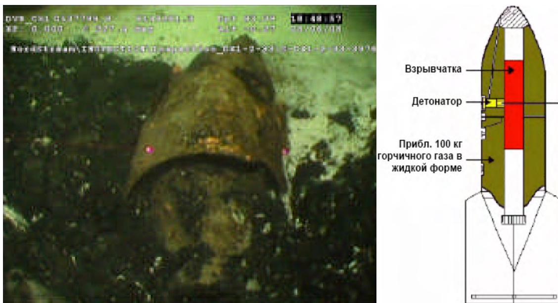
Рис. 2.23 DK1-2-33-3976, Германская химическая бомба 250 с горчичным газом времен Второй мировой войны. Корпус сильно корродировал, и часть газа осталась внутри бомбы, прибл. до 30 кг
