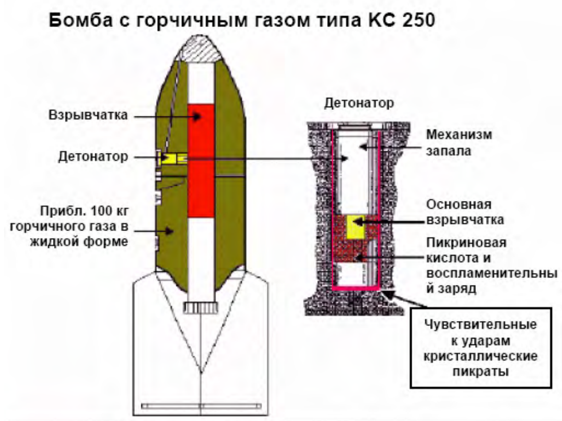
Рис. 2.7 Конструкция бомбы с горчичным газом Type КС 250
