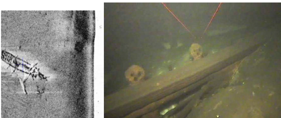
Kuva 6.2 Esimerkki Suomen talousvyöhykkeellä havaitusta hylystä: viistokaikuluotainkuva (vasemmalla) ja kauko-ohjatun laitteen ottama videokuva (oikealla)
