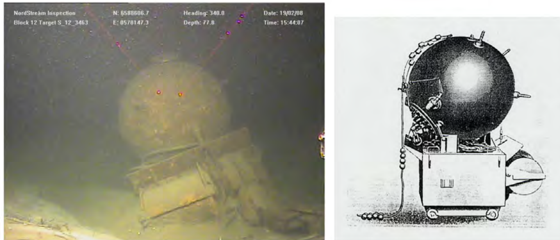
Kuva 6.1 Sotatarviketutkimuslöydösten ja historiallisten tietojen yhdenmukaisuus. Vasemmalla olevassa kuvassa on miina, jonka ankkurointimekanismi sijaitsee syvässä eroosion tuloksena syntyneessä onkalossa, jota ympäröi pehmeästä liejumaisesta savesta muodostuva tasainen merenpohja. Oikealla olevan piirustuksen perusteella kohde on tunnistettu saksalaiseksi toisen maailmansodan EMC I + II -kosketusmiinaksi, joka sisältää joko 250 kilon tai 320 kilon hexanite-räjähdysainepanoksen
