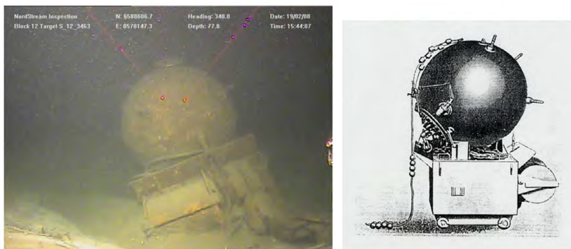
Рис. 6.1 Соотнесение результатов исследований боеприпасов с историческими данными. На снимке слева показана мина с якорным механизмом, расположенная в глубокой, размытой впадине, окруженной плоским морским дном из мягкой глины гиття. На основании чертежа справа, объект идентифицирован как немецкая якорная контактная мина EMC I + II времен Второй мировой войны, начиненная 250 кг или 320 кг гексanita
