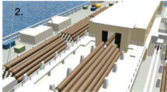
Rakentamisen alkaminen Jokainen putki tarkastetaan kuljetuksen jälkeen ja syötetään umpinaiseen valmistusasemaan putkijonoon liittämistä varten.
