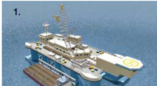
Putkien kuljettaminen putkenlaskualukselle Putkia toimitetaan putkenlaskualukselle proomuilla tasaiseen tahtiin. Nord Streamin toimitusketju on tehokas ja ympäristöystävällinen.
