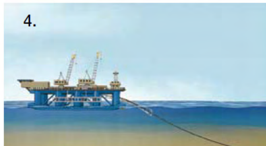
Merenpohjaan laskeminen Putkilinjan pidetessä putkenlaskualus liikkuu eteenpäin ja putkijonoa lasketaan merenpohjaan. Putkilinjaa voidaan rakentaa enimmillään kolme kilometriä vuorokaudessa.
