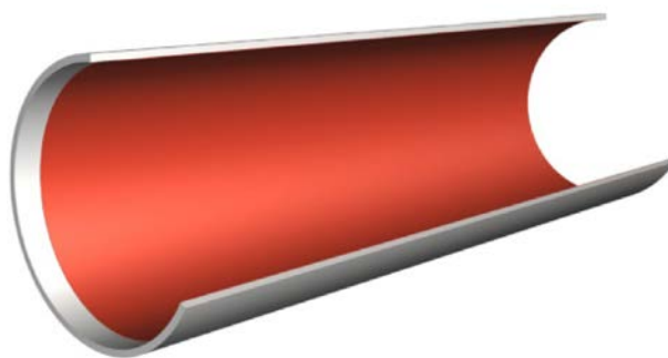
Abbildung 7: Innen wird eine Gleitbeschichtung auf Epoxidharzbasis aufgebracht.
