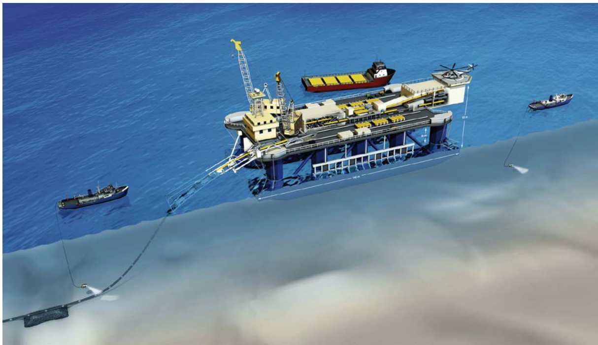
Abbildung 12: Verleges Schiff mit S-Verlegetechnik und Unterstützungsschiffe für Untersuchungen
